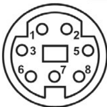
Рисунок 1.4 – Подключение вычислителя к контактным интерфейсам через разъём МИР посредством кабеля MDN
