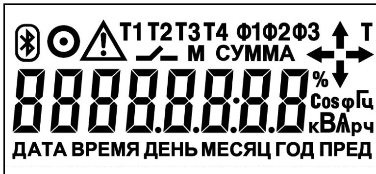
Рисунок 4.10 – Внешний вид ЖКИ счетчика с индексом «ш» в коде
